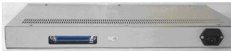
Рис. 2а Вид сзади МБС-Uрп с питанием от сети переменного тока ~220В/50Гц
