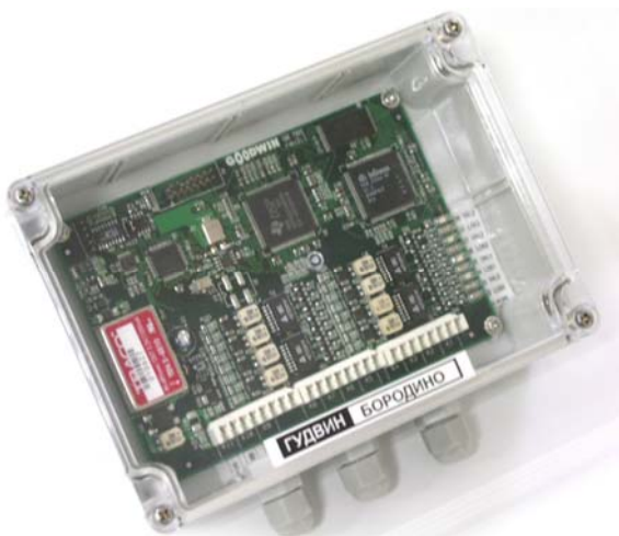
Рис. 10 Общий вид мультиплексора МБС-Е1 со снятой крышкой
